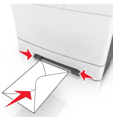
**2** Τοποθετήστε χαρτί στο χειροκίνητο τροφοδότη μέχρι το σημείο που η άκρη του εφάπτεται με τους οδηγούς χαρτιού.
