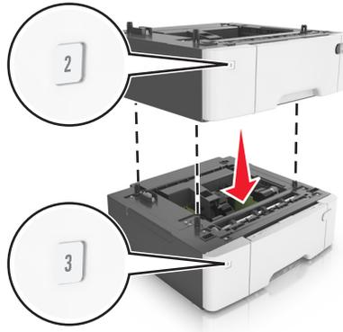
**4** 将打印机与 650 页双层进纸匣对齐，然后将打印机向下放到位。
