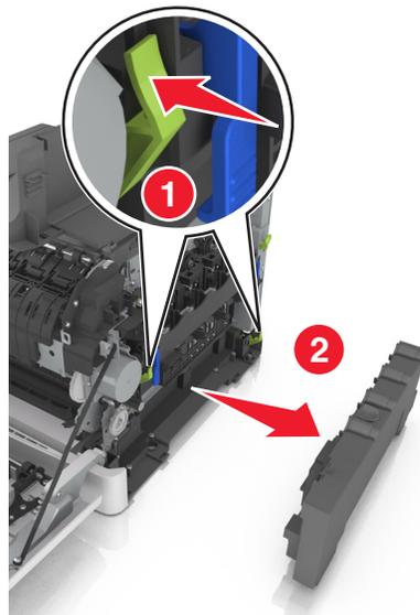
6 抬起成像组件上的蓝色控制杆，然后拉成像组件，直到停止。
