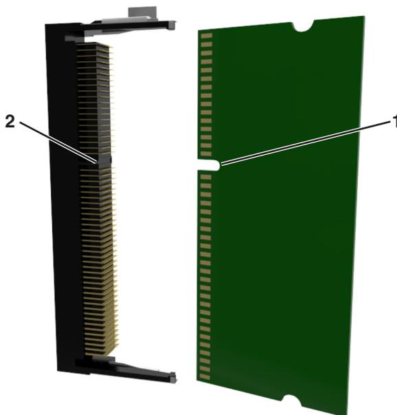
4 将内存卡笔直推入连接器中，然后将卡朝着控制器板墙推，直到它发出**咔嚓**一声，卡入到位。
