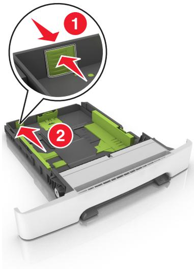
**3** 压住长度导片凸柱，然后将它滑动到与所加载的纸张尺寸相符的正确位置上。
