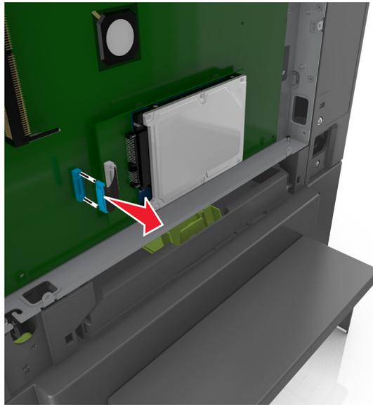
**3** 通过将打印机硬盘拉离控制器板来移除它。
