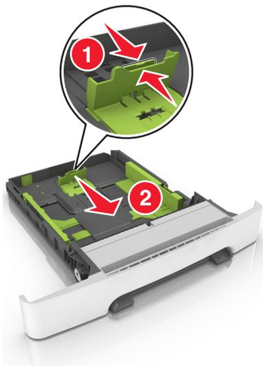
**注意：** 请使用进纸匣底部的纸张尺寸指示器来帮助放置导片。
