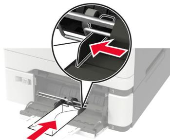
**Avertissement—Danger potentiel** : n'utilisez pas d'enveloppes avec timbre, agrafe, fermoir, fenêtre, revêtement intérieur couché ou bande autocollante.
