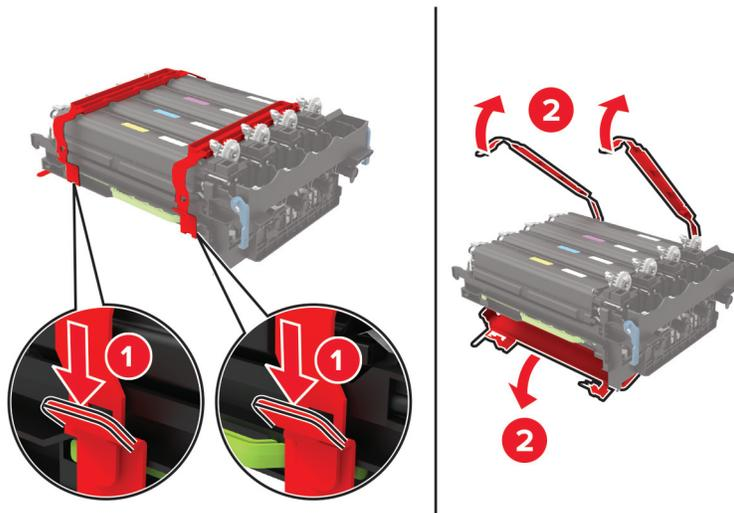
**Nota:** Se si sostituisce il kit imaging nero, inserire le unità sviluppatore magenta, ciano e giallo nel nuovo kit imaging.
