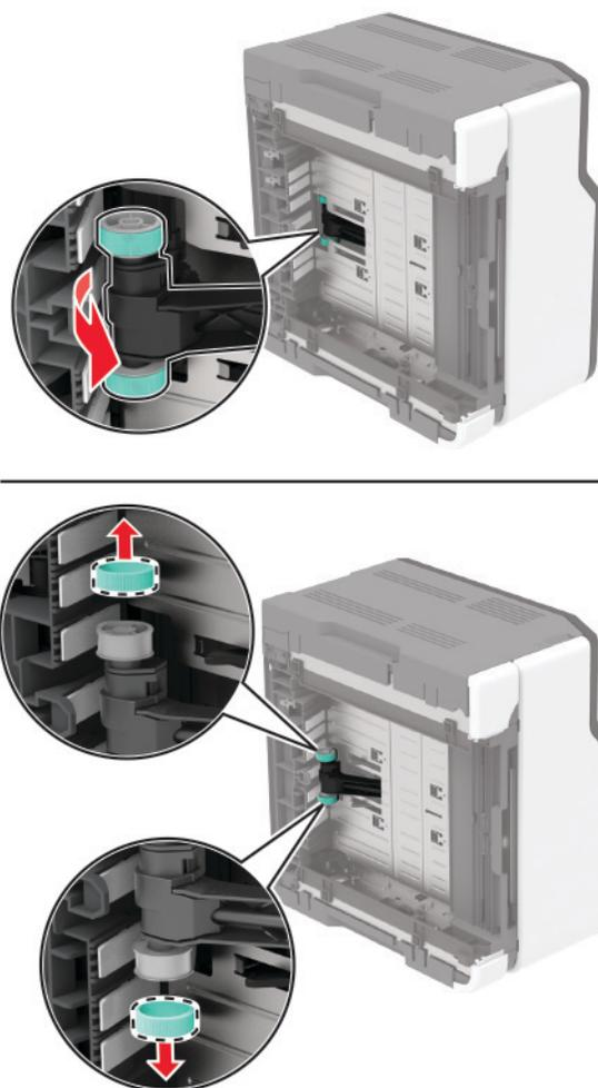
**11** Нанесите изопропиловый спирт на мягкую безворсовую ткань, а затем протрите шины ролика захвата.
