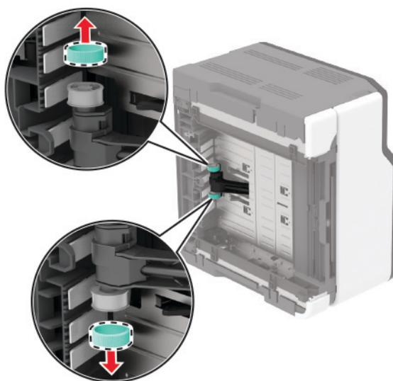
**11** Распакуйте новые шины ролика захвата.
