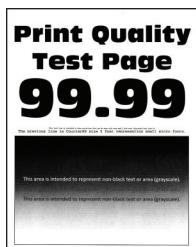
**Napomena:** Pre rešavanja ovog problema odštampajte stranicu testa kvaliteta. U kontrolnoj tabli idite na **Postavke > Rešavanje problema > Štampanje stranica testa kvaliteta**. Ako imate model štampača bez ekrana osetljivog na dodir, pritisnite **OK** za kretanje kroz postavke.
