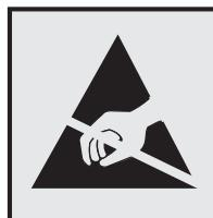
Ovaj simbol označava delove osetljive na statički elektricitet. Nemojte da dodirujete oblasti blizu ovih simbola, a da prethodno niste dodirnuli metalnu površinu u oblasti dalje od simbola.
