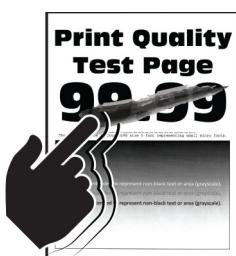
**Napomena:** Pre rešavanja ovog problema odštampajte stranice testa kvaliteta. U kontrolnoj tabli idite na **Postavke > Rešavanje problema > Štampanje stranica testa kvaliteta**. Ako imate model štampača bez ekrana osetljivog na dodir, pritisnite **OK** za kretanje kroz postavke.
