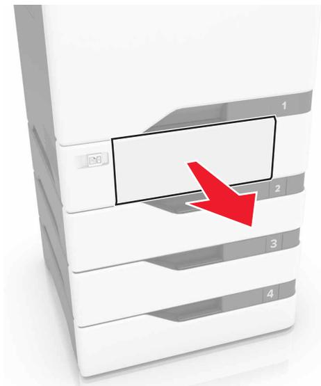
**تحذير—تلف محتمل:** تتعرض أداة الاستشعار المتوفرة داخل الدرج الاختياري للتلف بسهولة بسبب الكهرباء الاستاتيكية. المس سطحاً معدنياً قبل إزالة الورق المنحشر من الدرج.
