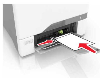
**警告—破損の恐れあり:** 切手、留め金、スナップ、窓、つや出し加工された内張り、封かん用口糊の付いた封筒は使用しないでください。
