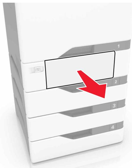
**警告—破損の恐れあり:** オプショントレイの内部のセンサーは、静電気によって故障することがよくあります。トレイにつまつた用紙を取り除く前に、金属の表面に手を触れてください。
