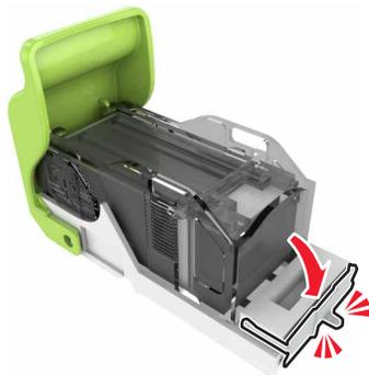
**5** Setzen Sie die Halterung der Heftklammerkassette ein.
