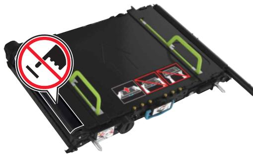
**8** Setzen Sie das neue Übertragungsband ein, bis es hörbar einrastet.
