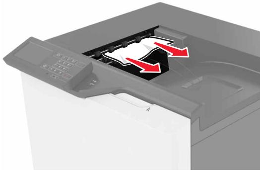
2 Öffnen Sie Klappe B, und entfernen Sie dann sämtliche Papierteile.
