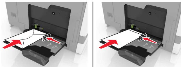
**Attention — Dommages potentiels :** n'utilisez pas d'enveloppes avec timbre, agrafe, fermoir, fenêtre, revêtement intérieur couché ou bande autocollante.
