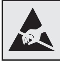
هذا الرمز يحدد الأجزاء الحساسة للكهرباء الاستاتيكية. لا تلمس المناطق القريبة من هذه الرموز دون لمس سطح معدني أولاً في منطقة بعيدة من الرمز. لتجنب حدوث تلف ناجم عن التفريغ الكهربائي عند تنفيذ مهام الصيانة مثل إزالة انحشار الورق أو استبدال المستلزمات، المس أي إطار معدني مكشوف للطابعة قبل الوصول إلى المناطق الداخلية في الطابعة أو لمسها حتى إذا لم يكن الرمز موجوداً.
