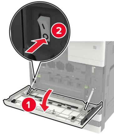
2 افصل سلك الطاقة من مأخذ التيار الكهربائي ثم من الطابعة.
