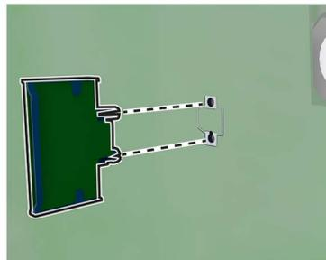
**Hinweis:** Der Steckverbinder auf der Karte muss über die gesamte Länge bündig an der Controller-Platine anliegen.
