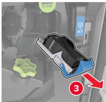
**3** Entfernen Sie die losen Heftklammern.
