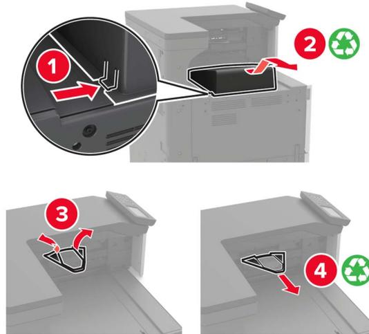
6 Entfernen Sie die Papierführungen mithilfe des Schraubendrehers in Klappe A.
