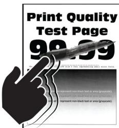
**Hinweis:** Drucken Sie die Seiten für Druckqualitätstests aus, bevor Sie das Problem beheben. Gehen Sie an der Bedienerkonsole zu **Einstellungen > Fehlersuche > Seiten für Druckqualitätstests ausdrucken**.
