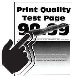
**Napomena:** Prijed rješavanja problema ispišite stranice za ispitivanje kvalitete ispisa. S upravljačke ploče dođite do opcije **Postavke > Rješavanje problema > Ispiši stranicu za ispitivanje kvalitete ispisa**. Za kretanje kroz postavke modela pisača bez dodirnog zaslona pritisnite **OK**.
