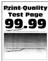
**Napomena:** Prije rješavanja problema ispišite stranicu za ispitivanje kvalitete ispisa. Na upravljačkoj ploči dođite do opcije **Postavke > Rješavanje problema > Ispiši stranicu za ispitivanje kvalitete ispisa**. Za kretanje kroz postavke modela pisača bez dodirnog zaslona pritisnite **OK**.
