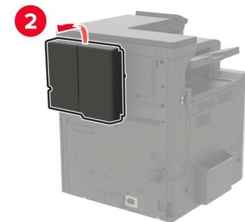
5 コントローラボードのアクセスカバーを取り外します。
