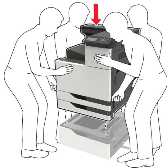
16 3000 枚トレイをプリンタに合わせ、取り付け支柱を取り付けます。
