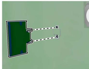
9 シールドを取り付け、アクセスカバーを取り付けます。
