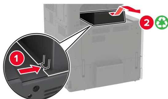
5 接着力バーを取り外し、用紙仕切りを取り外します。
