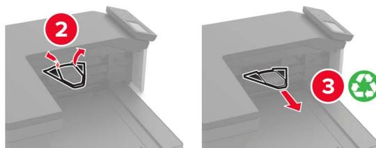
6 使用存储在盖门 A 内部的螺丝起子移除纸张导片传感器和滑轨的盖板。
