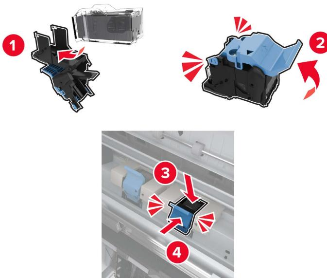
5 Vratite uređaj za pravljenje brošura na mesto, a zatim zatvorite vrata.
