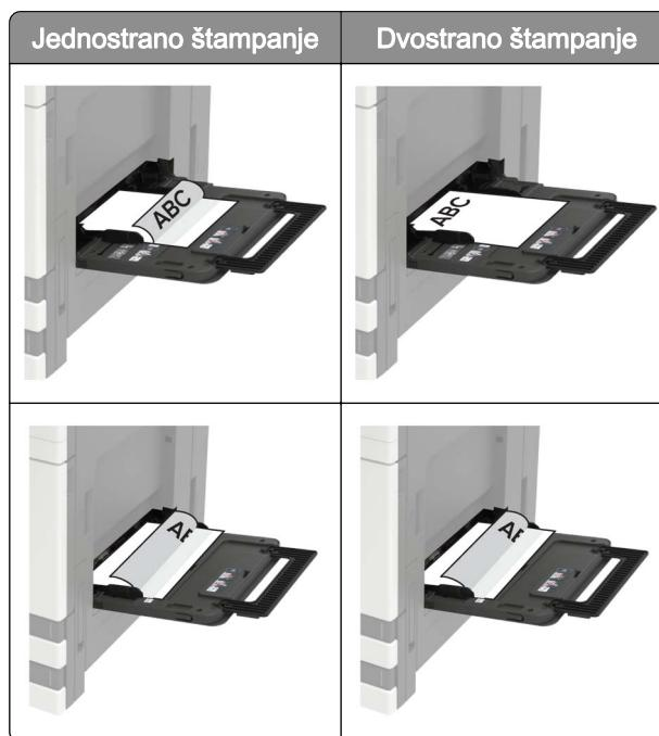
**Upozorenje – potencijalno oštećenje:** Nemojte da koristite koverte sa markicama, spajalicama, prozorima, premazima ili samolepljivim trakama.
