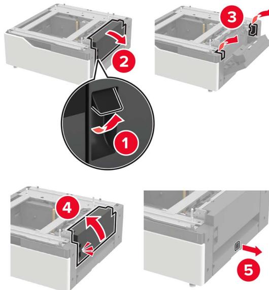
11 Otvorite fioku, a zatim uklonite nosač za montiranje i poklopce šina.
