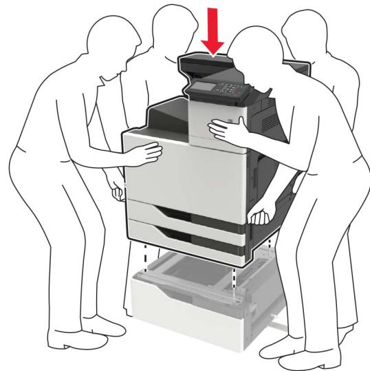
16 Poravnajte fioku od 3000 listova sa štampačem, pa postavite držać za montiranje.
