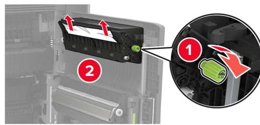
**3** Otvorite standardne fioke, a zatim uklonite zaglavljeni papir.
