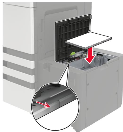
**4** Spustite valjak za uvlačenje, a zatim zatvorite vrata.
