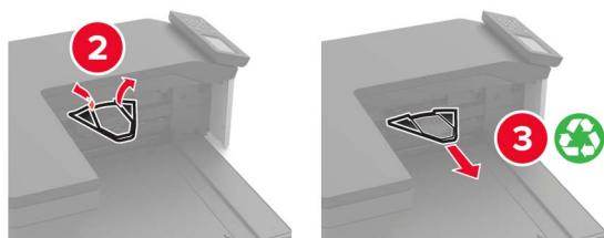
6 利用存放在 A 門內的螺絲起子，取出紙張導引夾感應器和滑軌的蓋板。
