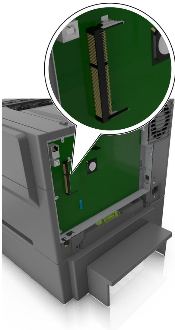
**Advertencia: Posibles daños:** Los componentes electrónicos de la placa de la controladora se dañan fácilmente con la electricidad estática. Toque la superficie metálica de la impresora antes de tocar cualquier conector o componente electrónico de la placa controladora.
