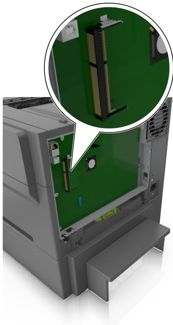
**Attenzione - Possibili danni:** i componenti elettrici della scheda del controller sono facilmente danneggiati dall'elettricità statica. Prima di toccare un componente o connettore elettronico della scheda del controller, toccare una superficie metallica.
