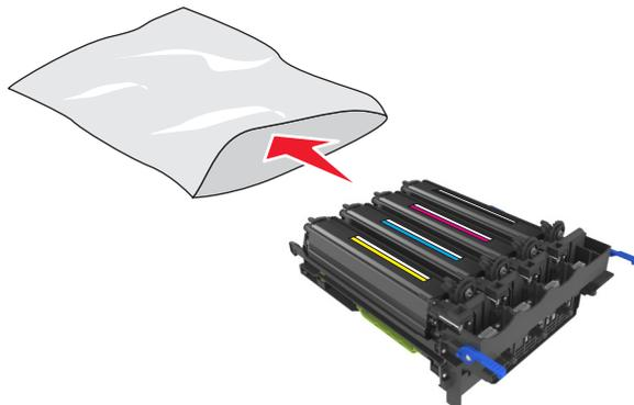
**Nota:** quando si sostituisce il kit imaging nero, non rimuovere le unità sviluppatore ciano, magenta e giallo. Smaltire solo l'unità sviluppatore nero.
