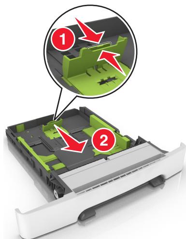
**注意:** 请使用进纸匣底部的纸张尺寸指示器来帮助放置导片。
