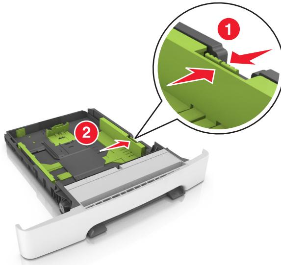
**注意:** 请使用进纸匣底部的纸张尺寸指示器来帮助放置导片。
