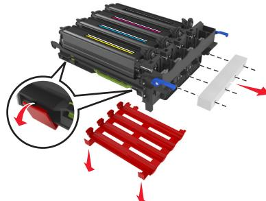
**警告—可能的损坏：**请勿触摸成像组件下面发亮的感光鼓。否则会影响以后打印作业的质量。
