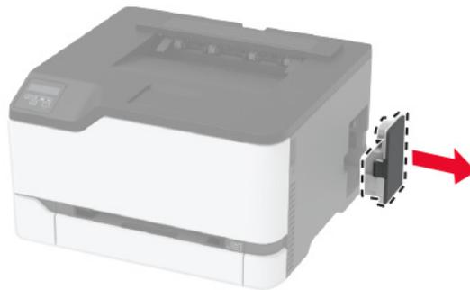
**Nota:** Para evitar que se derrame el tóner, coloque la botella en posición vertical.
