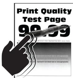
**Napomena:** Pre rešavanja ovog problema odštampajte stranice testa kvaliteta. U kontrolnoj tabli idite na **Postavke > Rešavanje problema > Štampanje stranica testa kvaliteta**. Ako imate model štampača bez ekrana osetljivog na dodir, pritisnite **OK** za kretanje kroz postavke.
