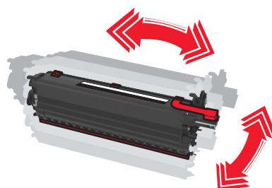
11 移除顯像組件上的紅色包裝條狀物及所連接的布材。
