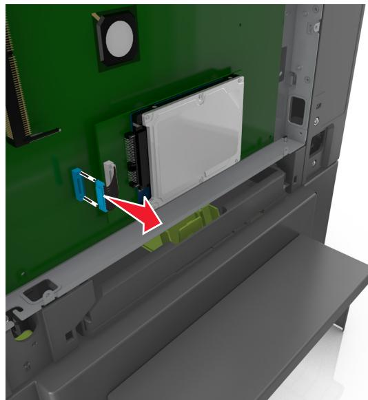
**3 將印表機硬碟從控制板中拉出後取下。**
