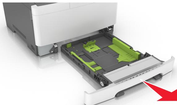
**2** 若紙張長度超過 Letter 尺寸的紙張，請捏住紙匣組件後方的長度導引夾，然後滑動它，來延伸長度。
