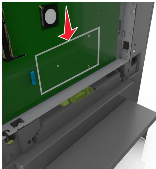
5 將印表機硬碟的外螺紋螺絲對準控制板的孔洞，然後將印表機硬碟往下壓，讓外螺紋螺絲卡入定位。
