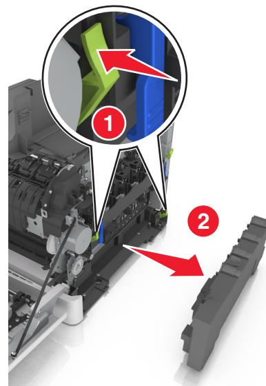
6 拉起成像套件上的藍色壓桿，然後拉移成像套件，直到它停止。
