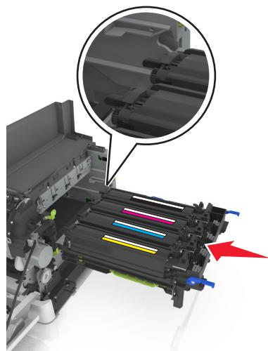
**13** 將藍色壓桿往下壓，直到成像套件卡入定位。
