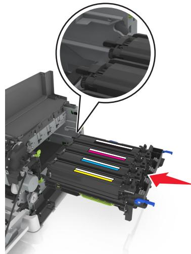
**15** 將藍色壓桿往下壓，直到成像套件卡入定位。
