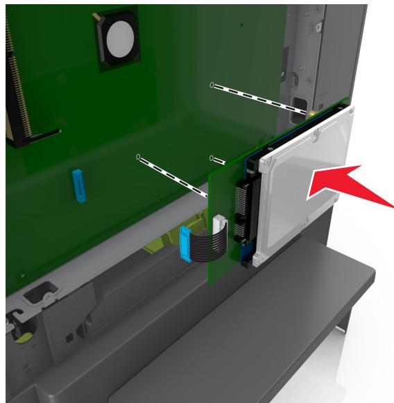
6 將印表機硬碟介面電纜的插頭，插入控制板上的連結器。
