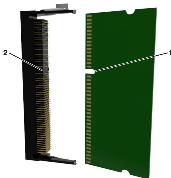
4 將記憶卡直接推入連接器中，然後將它推向控制板內壁，直到它卡入定位。
