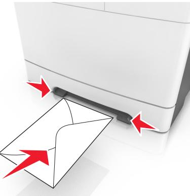
**2** 將紙張送入手動輔助式送紙器時，只能送至紙張前緣接觸到紙張導引夾的位置。
