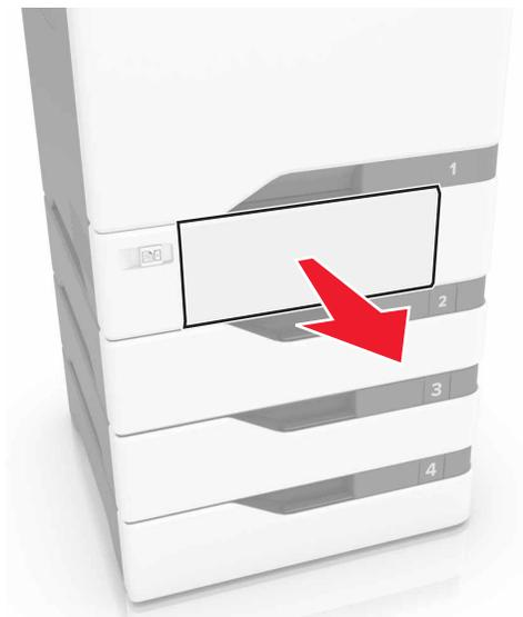
**Avertissement—Danger potentiel :** Un capteur dans le tiroir facultatif peut facilement être endommagé par l'électricité statique. Touchez une surface métallique avant de retirer le papier coincé dans le tiroir.
