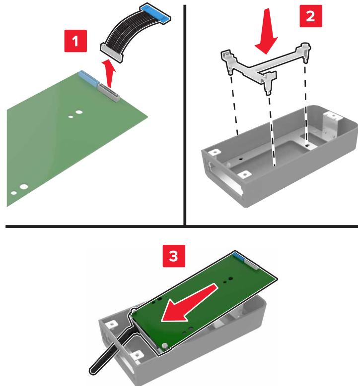
5 将护罩安装在控制器板通道盖板上。
