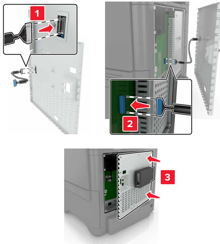
7 重新安装控制器板通道盖板。
