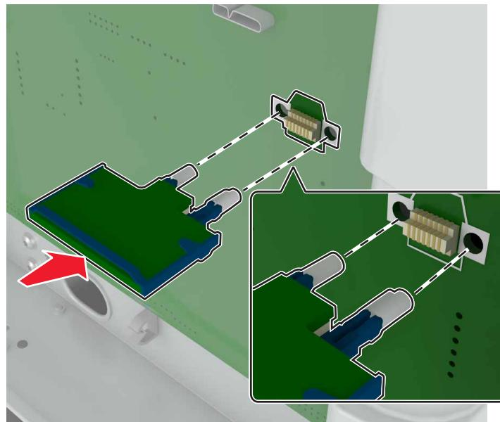
**注意:** 卡上的整个连接器必须完全接触控制器板，并平整地挨着控制器板。
