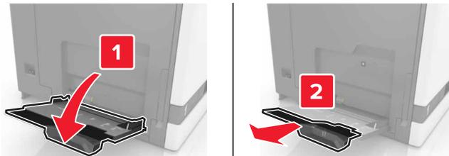
2 Ajuste la guía para que coincida con el tamaño del papel que va a cargar.
