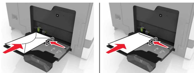
**Avertissement—Danger potentiel :** n'utilisez pas d'enveloppes avec timbre, agrafe, fermoir, fenêtre, revêtement intérieur couché ou bande autocollante.
