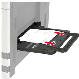
3 Öffnen Sie Klappe C und entfernen Sie sämtliche Papierteile.
