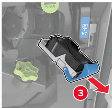
**3** Entfernen Sie die losen Heftklammern.
