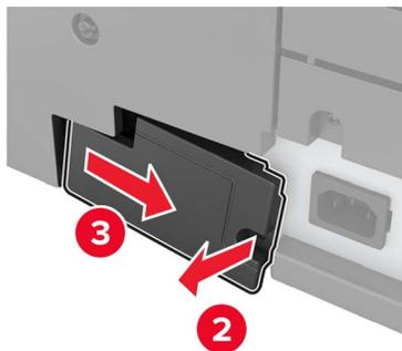
4 Si l'imprimante est équipée d'un capot de filtre, retirez-le.
