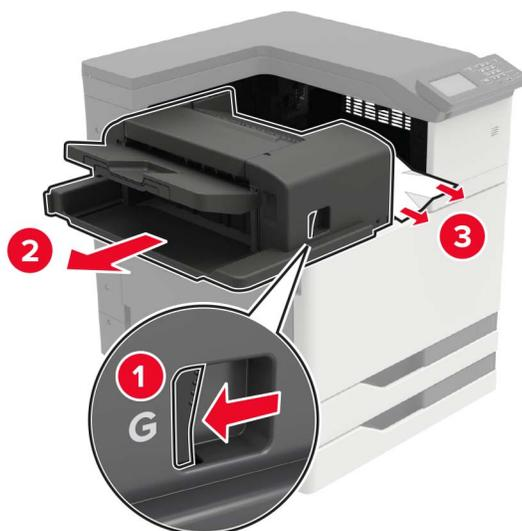
Si nécessaire, tournez la roue tournante G1 vers le bas pour insérer le papier coincé dans le réceptacle d'unité de finition, puis retirez le papier coincé.
