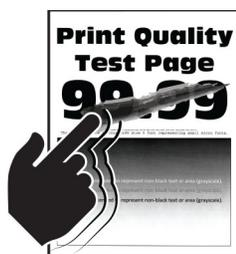
**メモ:** 問題を解決する前に、印刷品質テストページを印刷します。操作パネルから、[設定] > [トラブルシューティング] > [印刷品質テストページ] の順に移動します。タッチ画面のないプリンタ機種では、**OK** を押して設定内を移動します。
