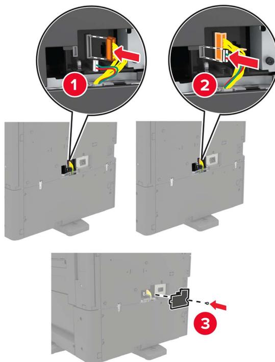
**23** Abra as bandejas 2 e 3 e, em seguida, fixe a bandeja para 2x500 ou para 2500 folhas à impressora com os cliques de fixação e o suporte de metal.
