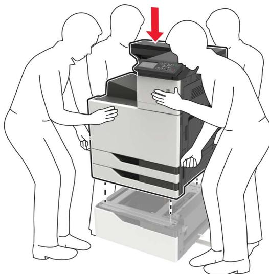
**16** Alinhe a bandeja para 3000 folhas à impressora e encaixe o pino de montagem.
