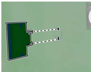
**Nota:** Todo o comprimento do conector na placa deve tocar e ficar encostado na placa do controlador.
