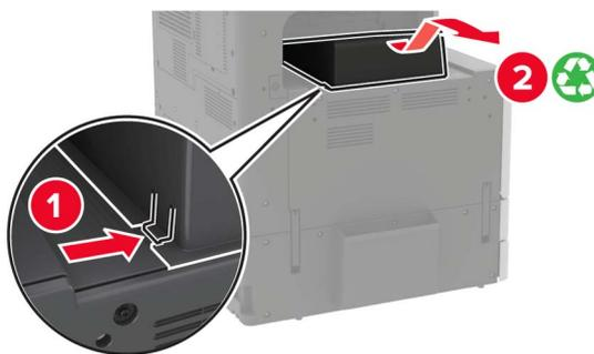
**5** Remova a tampa adesiva e, em seguida, remova o depósito de papel.
