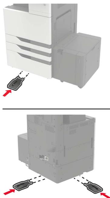
**22** Encaixe o conector da bandeja para 2x500 ou para 2500 folhas à impressora.
