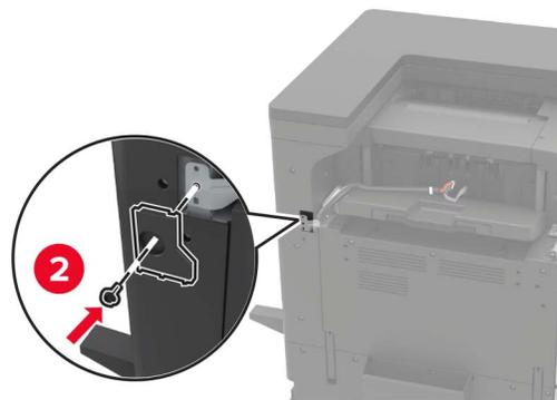
**11** Encaixe a tampa do trilho de deslizamento do encadernador.
