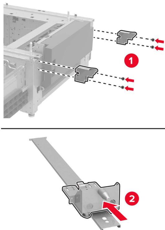
**13** Encaixe o trilho e, em seguida, encaixe o suporte de montagem e as tampas do trilho.
