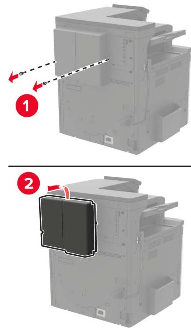
**5** Снимите защитную крышку системной платы.
