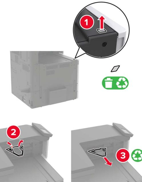
**6** Отверткой, которая хранится в дверце А, снимите крышки датчиков направляющих бумаги и сдвиньте направляющую.
