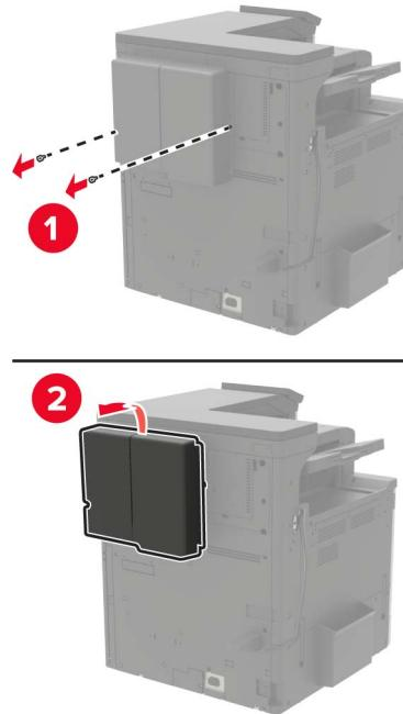
5 Снимите защитную крышку системной платы.
