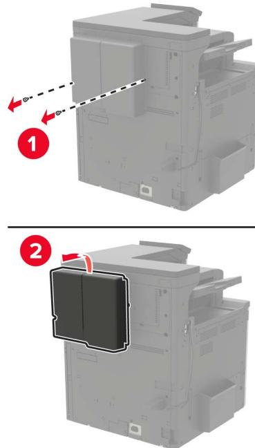
5 Снимите защитную крышку системной платы.
