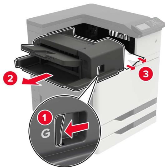
При необходимости проверните колесико G1 вниз, чтобы подать замятую бумагу в выходной лоток брошюровщика, затем уберите замятую бумагу.
