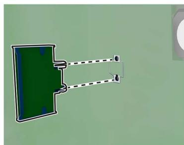
9 Установите щиток, затем установите крышку доступа.
