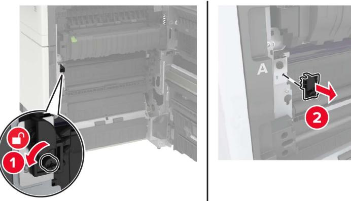
4 松开固定转印带的螺钉。
