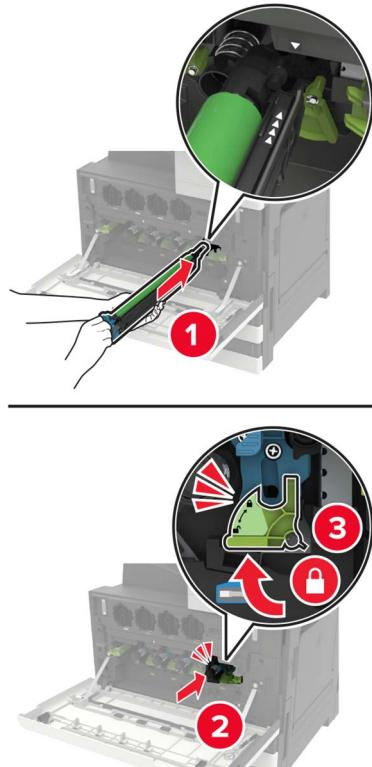
6 使用打印头刷片，清洁打印头镜片。
