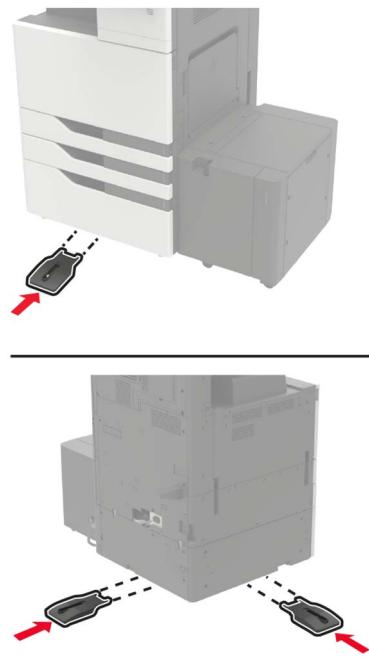
**22** 将 2 x 500 或 2500 页进纸匣连接器连接到打印机上。
