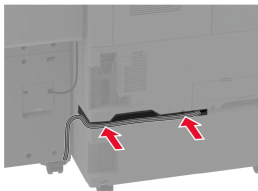
19 Povežite kabel za napajanje s pisačem, a zatim s električnom mrežnom utičnicom.
