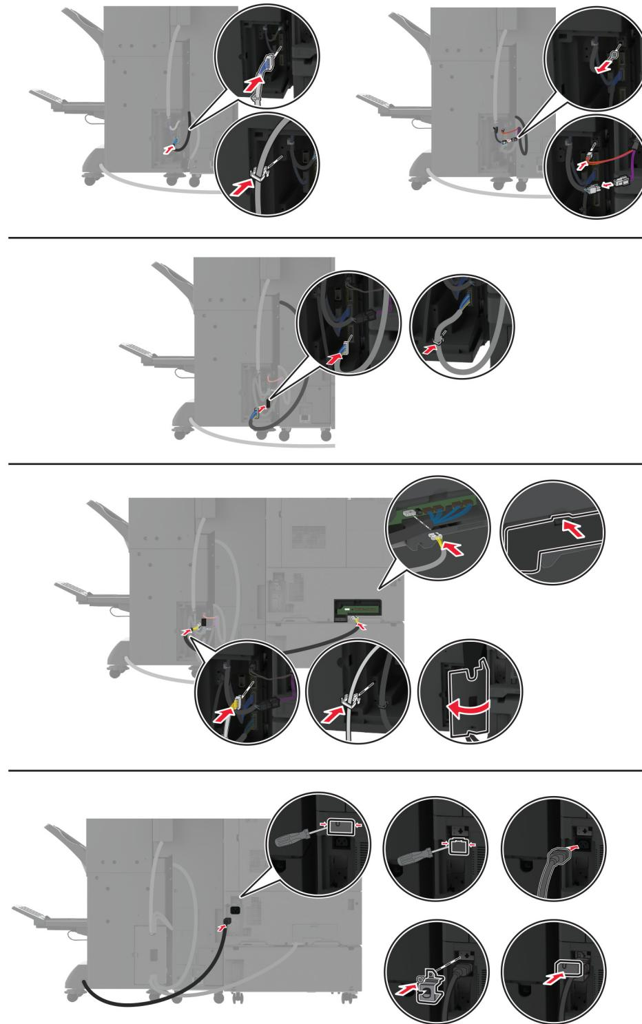
**19** Ukopčajte kabele za napajanje pisača i sklopa za završnu obradu u pisač i sklop za završnu obradu, a zatim u električnu utičnicu.
