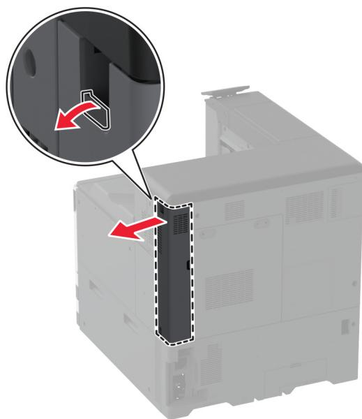
2 Ravnim odvijačem odvojite iskorišteni pristupni poklopac ploče upravljača.
