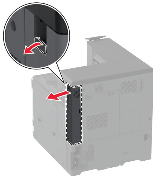
3 Iskopčajte kabel za napajanje iz električne mrežne utičnice, a zatim iz pisača.
