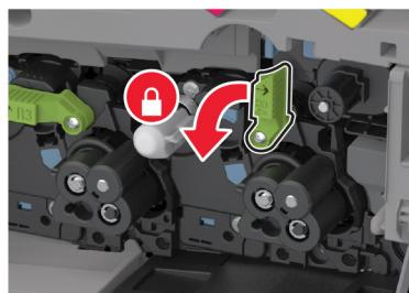
8 Uklonite brisač glave za ispis i zatim očistite leće glave za ispis.
