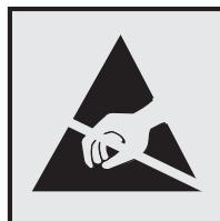
Ovim simbolom označeni su dijelovi koji su osjetljivi na statički elektricitet. Nemojte dodirivati područja blizu ovih simbola, a da prije toga ne dodirnete metalnu površinu u području dalje od simbola.
