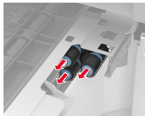
6 Nanesite vodu na meku krpu koja ne ostavlja dlačice i zatim obrišite valjke za uvođenje.
