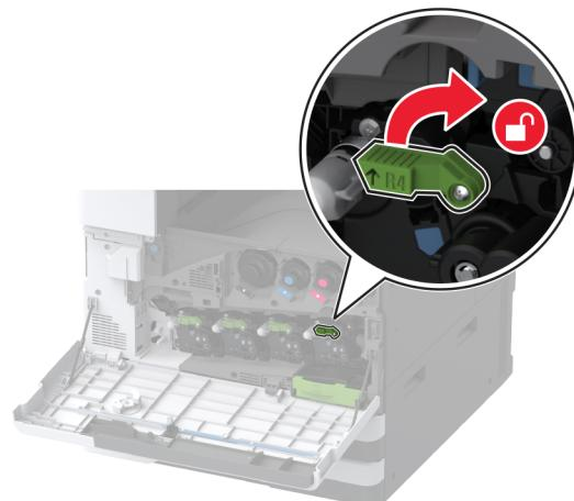
**4** Izvadite potrošenu jedinicu fotovodiča.
