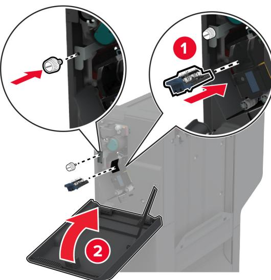
5 Pričvrstite nosače na sklop za završnu obradu.
