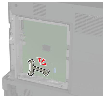
**7** Pričvrstite ISP na nosač za montažu.
