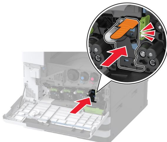
7 Uklonite materijal pakiranja, a zatim zaključajte novu jedinicu fotovodiča.
