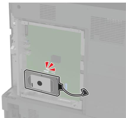
7 Priklučite spojni kabel tvrdog diska na ploču upravljača.
