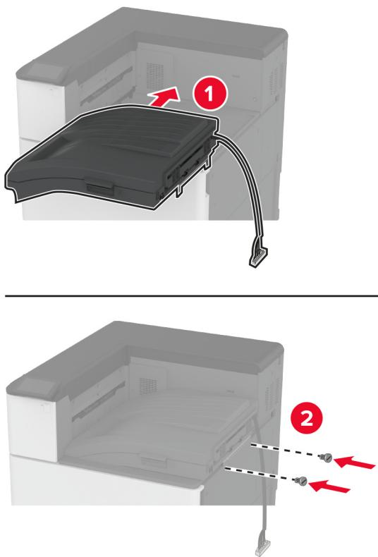
**12** Povežite sklop za završnu obradu s pisačem.
