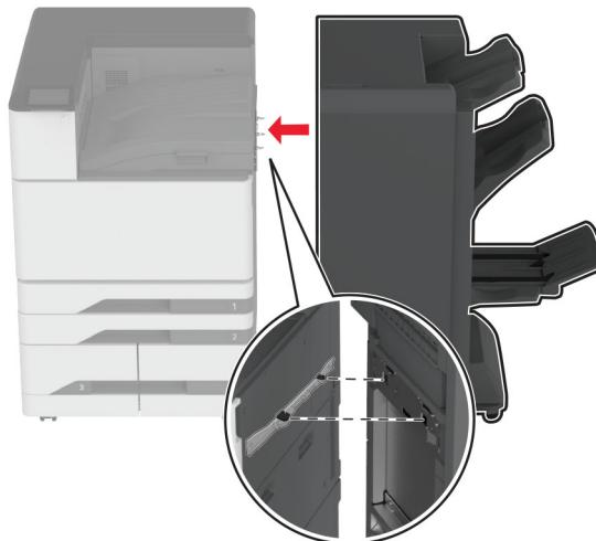
**24** Otvorite vratašca sklopa za završnu obradu, vijkom pričvrstite sklop za završnu obradu na pisač i zatim zatvorite vratašca.
