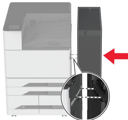
**11** Otvorite vratašca sklopa za završnu obradu s trostrukim/Z presavijanjem, vijkom pričvrstite sklop za završnu obradu na pisač i zatim zatvorite vratašca sklopa za završnu obradu.
