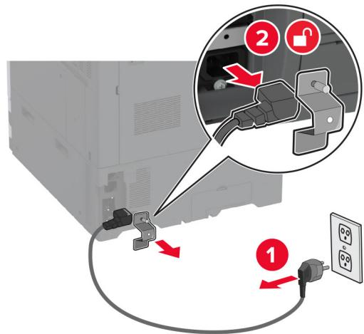
3 Iskopčajte kabele sklopa za završnu obradu knjižica iz pisača.
