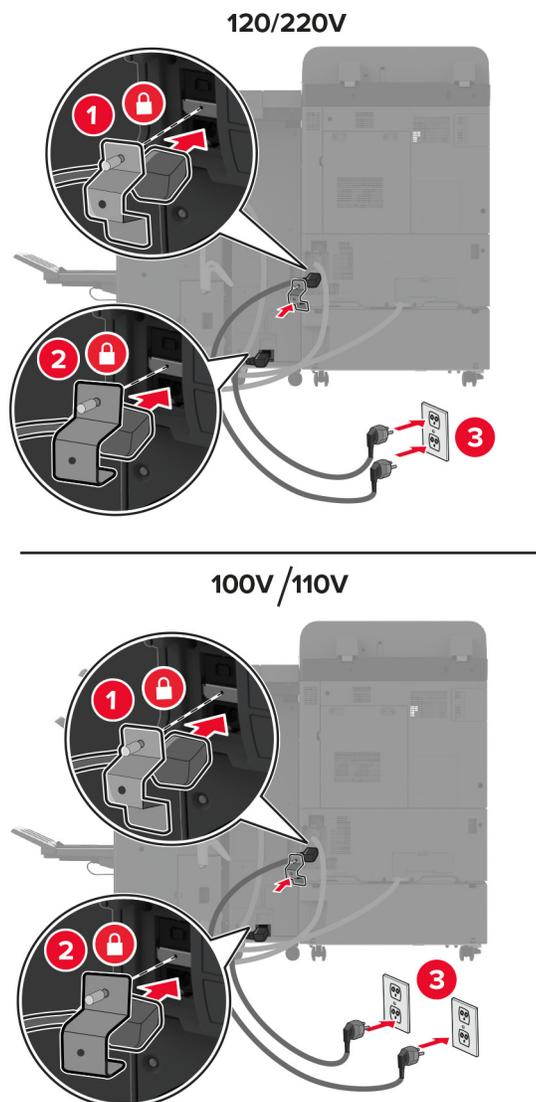
**Nota:** se la presa è da 120 o 220 V, è possibile collegare entrambi i cavi di alimentazione alla stessa presa. Se la presa è da 100 o 110 V, è necessario collegare i cavi di alimentazione a prese separate.
