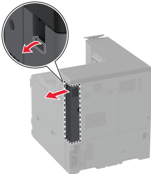
**2** Utilizzando un cacciavite a testa piatta, rimuovere il coperchio usato di accesso alla scheda del controller.
