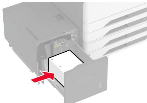
**Nota:** Accertarsi che l'altezza della risma non superi l'indicatore di livello massimo della carta. Il caricamento eccessivo del vassoio può causare inceppamenti.
