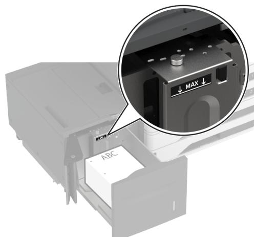
**6** Zatvorite bočna vrata fioke, a zatim umetnite fioku.
