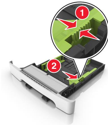
**注意：**请使用进纸匣底部的纸张尺寸指示器来帮助放置导片。
