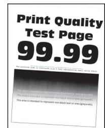
**ملاحظة:** قبل حل المشكلة، اطبع صفحات اختبار جودة الطباعة. من لوحة التحكم، انتقل إلى الإعدادات < استكشاف الأخطاء وإصلاحها < صفحات اختبار جودة الطباعة. في طرازات الطابعات المزودة بشاشات لا تعمل باللمس، اضغط على **OK** للانتقل عبر الإعدادات.
