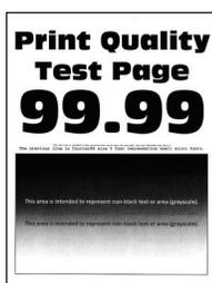
**メモ:** 問題を解決する前に、印刷品質テストページを印刷します。操作パネルから、**[設定]** > **[トラブルシューティング]** > **[印刷品質テストページ]**の順に移動します。タッチ画面のないプリンタ機種では、**OK** を押して設定内を移動します。
