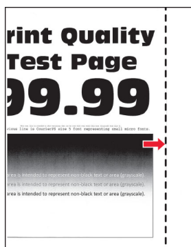
Feilplasserte marger på side 212
