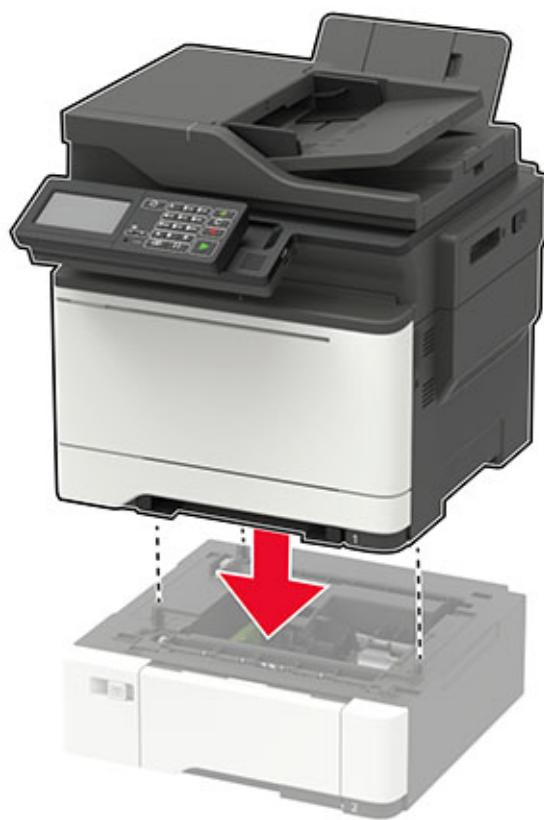
**注意：**如果您安装两个进纸匣选件，请将 550 页进纸匣放在 650 页双层进纸匣的下面。
