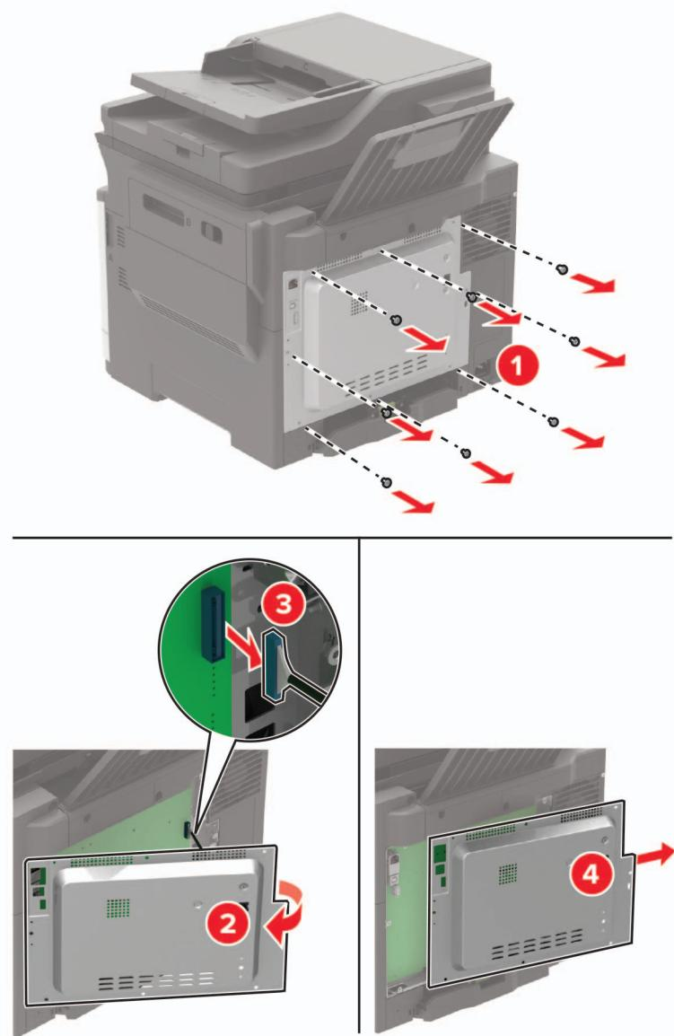
**4 安装通道盖板。**
