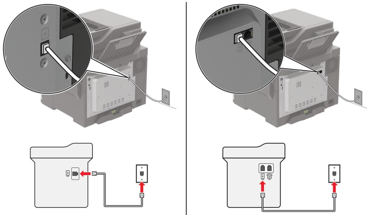
**1** 将电话线的一端连接到打印机的线路端口。
