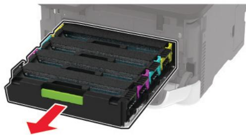
**5** Pentru a evita contaminarea cauzată de scurgerea tonerului, plasați o coală de hârtie pe partea superioară a tăvii cartușului de imprimare și apoi introduceți tava cartușului de imprimare.
