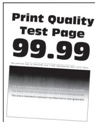
**Notă:** Înainte de soluționarea problemei, imprimați paginile de testare a calității imprimării. Din panoul de control, accesăți **Setări > Depanare > Pagini de testare a calității imprimării**. Pentru modelele de imprimantă care nu dispun de ecran tactil, apăsați **OK** pentru a naviga printre setări.
