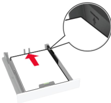
**4** Reglați ghidajele pentru a se potrivi cu dimensiunea hârtiei pe care o încărcați.
