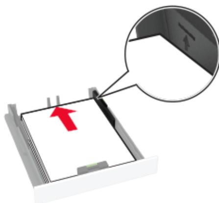
**4** 调整导片以匹配加载的纸张尺寸。
