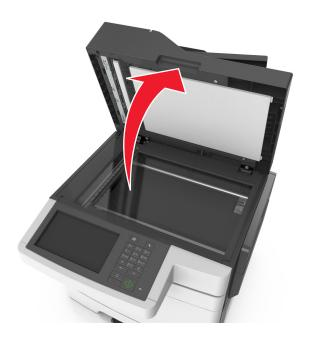
**3** Reinigen Sie die abgebildeten Bereiche und lassen Sie sie dann trocknen.
