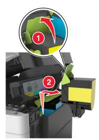
**3** Nehmen Sie die neue Tonerkassette aus der Verpackung und entfernen Sie das Verpackungsmaterial.
