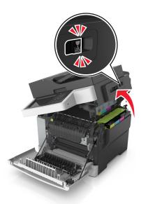
**3** Nehmen Sie die Druckkassetten aus dem Drucker, indem Sie die Griffe nach oben drücken und dann die Kassetten vorsichtig vom Belichtungskit weg ziehen.
