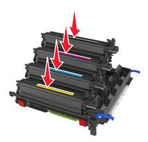
**Hinweis:** Stellen Sie sicher, dass jede Entwicklereinheit in den entsprechenden farblich markierten Schacht gesetzt wird.
