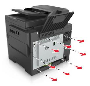
**2** Öffnen Sie leicht die Abdeckung der Steuerungsplatine und schieben Sie sie dann nach rechts, um sie abzunehmen.
