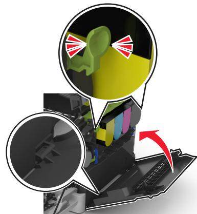
9 Skyv og hold utløserhåndtaket på høyre side av skriveren, og lukk toppdekselet forsiktig.
