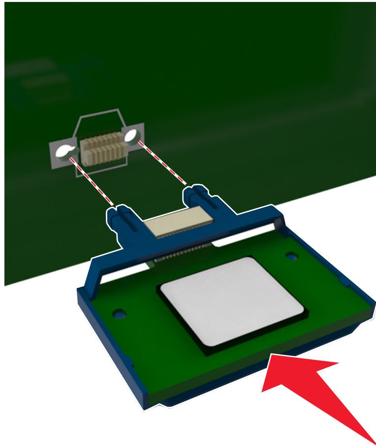
**Advarsel – mulig skade:** Hvis kortet ikke installeres på riktig måte, kan det føre til skade på kortet og kontrollerkortet.
