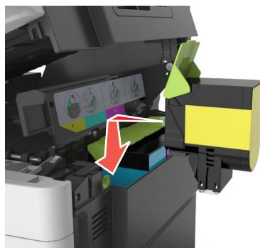
**5** Skyv og hold utløserhåndtaket på høyre side av skriveren, og lukk toppdekselet forsiktig.
