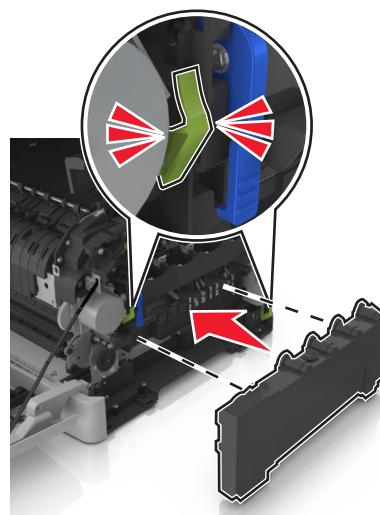
**15** Sett inn dekselet på høyre side.
