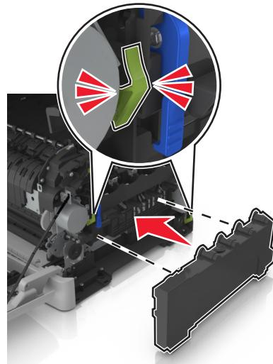
**17** Sett inn dekselet på høyre side.
