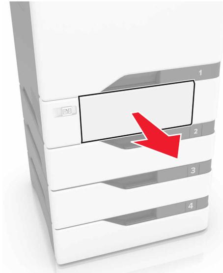
**Warnung—Mögliche Schäden:** Ein Sensor innerhalb des optionalen Fachs wird durch statische Aufladung leicht beschädigt. Berühren Sie einen Metallgegenstand, bevor Sie das verklemmte Papier in dem Fach entfernen.
