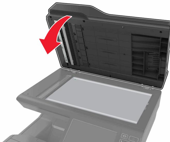
**6** Åpne skannerdekselet for å kontrollere at ADM-skannerputen er festet til dekselet.
