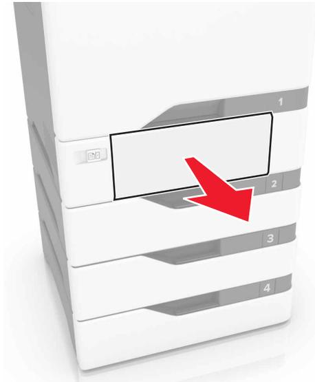
**Advarsel – mulig skade:** En sensor i den ekstra skuffen kan lett bli skadet av statisk elektrisitet. Ta på en metallflate før du fjerner fastkjørt papir fra skuffen.
