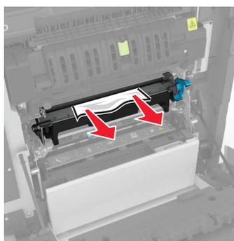
3 Åpne dekselet til fikseringsenheten.
