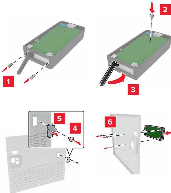
**6** Conecte o cabo de extensão ISP ao conector ISP da placa do controlador.
