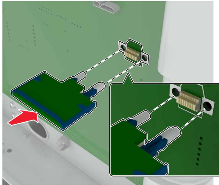
**Nota:** Todo o comprimento do conector na placa deve tocar e ficar encostado no painel do controlador.
