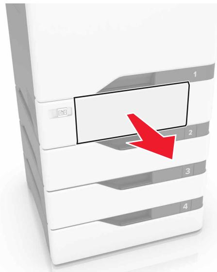
**Avertisment - Pericol de deteriorare:** Un detector aflat în interiorul tăvii opționale poate fi deteriorat cu ușurință de electricitatea statică. Atingeți o suprafață metalică înainte să scoateți hârtia blocată în tavă.
