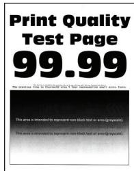
**Примечание:** Перед решением проблемы напечатайте образцы качества печати, чтобы определить отсутствующий цвет. На начальном экране коснитесь **Параметры > Устранение проблем > Страницы проверки качества печати.**
