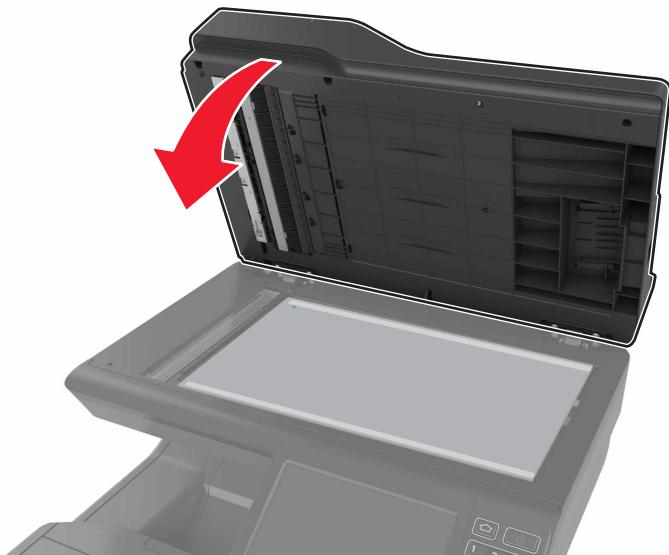
**6** Откройте крышку сканера, чтобы проверить степень крепления прокладки сканирования УАПД к крыше.
